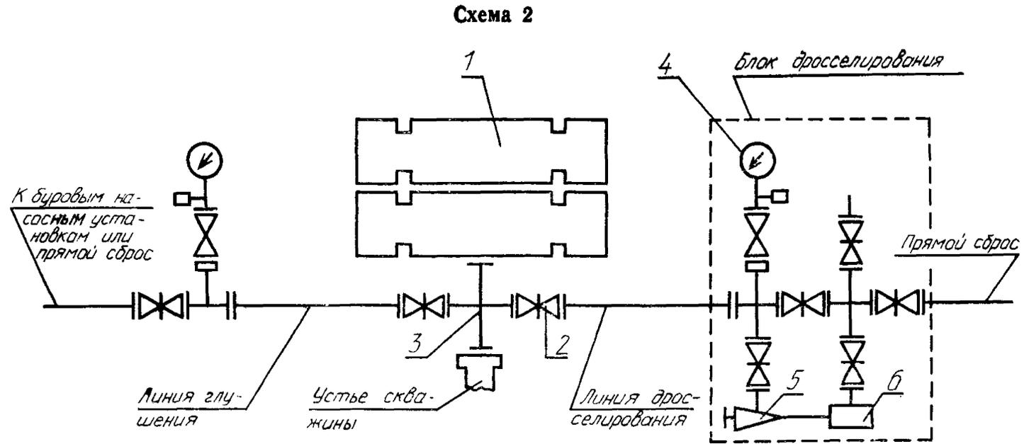
1 — плашечный превентор; 2 — задвижка с ручным управлением; 3 — устьевая крестовина; 4 — манометр с запорным и разрядным устройствами с разделителем сред; 5 — регулируемый дроссель с ручным управлением; 6 — гаситель потока
