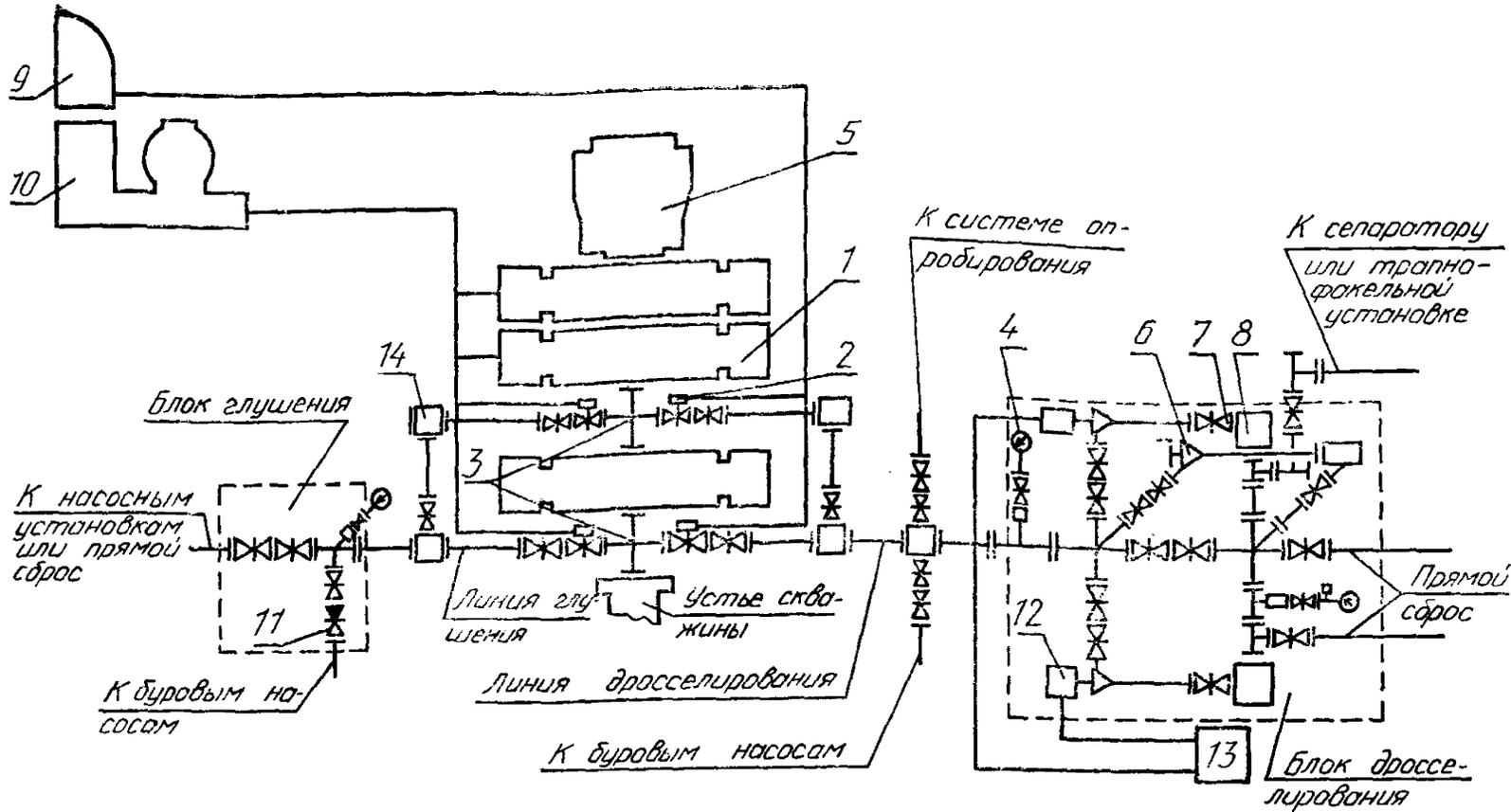
1 — плащечный превентор; 2 — задвижка с гидравлическим управлением; 3 — устьевая крестовина; 4 — манометр с запорным и разрядным устройствами и разделителем сред; 5 — кольцевой превентор; 6 — дроссель регулируемый с ручным управлением; 7 — задвижка с ручным управлением; 8 — гаситель потока; 9 — вспомогательный пульт; 10 — станция гидропривода; 11 — обратный клапан; 12 — регулируемый дроссель с гидравлическим управлением; 13 — пульт управления гидроприводным дросселем
