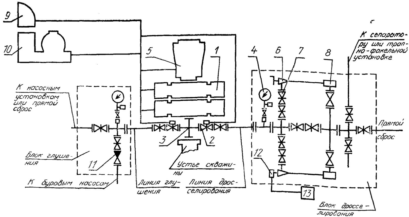
1 — плащечный превентор; 2 — задвижка с гидравлическим управлением; 3 — устьевая крестовина; 4 — манометр с запорным и разрядным устройствами и разделителем сред; 5 — кольцевой превентор; 6 — дроссель регулируемый с ручным управлением; 7 — задвижка с ручным управлением; 8 — гаситель потока; 9 — вспомогательный пульт; 10 — станция гидропривода; 11 — обратный клапан; 12 — регулируемый дроссель с гидравлическим управлением; 13 — пульт управления гидроприводным дросселем
