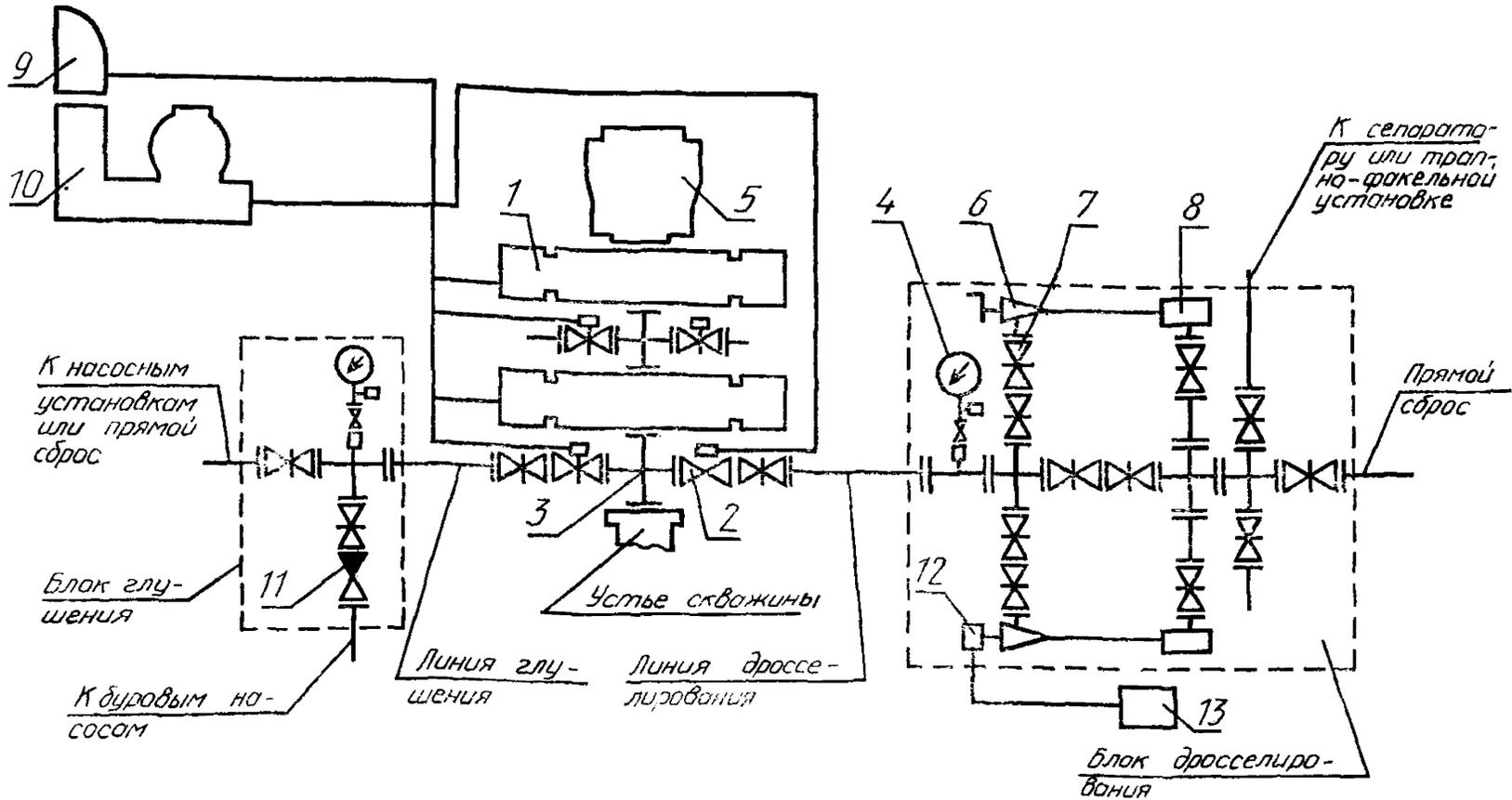
1 — плащечный преентор; 2 — задвижка с гидравлическим управлением; 3 — устьевая крестовина; 4 — манометр с запорным и разрядным устройствами и разделителем сред; 5 — кольцевой преентор; 6 — дроссель с ручным управлением; 7 — задвижка с ручным управлением; 8 — гаситель потока; 9 — вспомогательный пульт; 10 — станция гидропривода; 11 — обратный клапан; 12 — регулируемый дроссель с гидравлическим управлением; 13 — пульт управления гидроприводным дросселем
