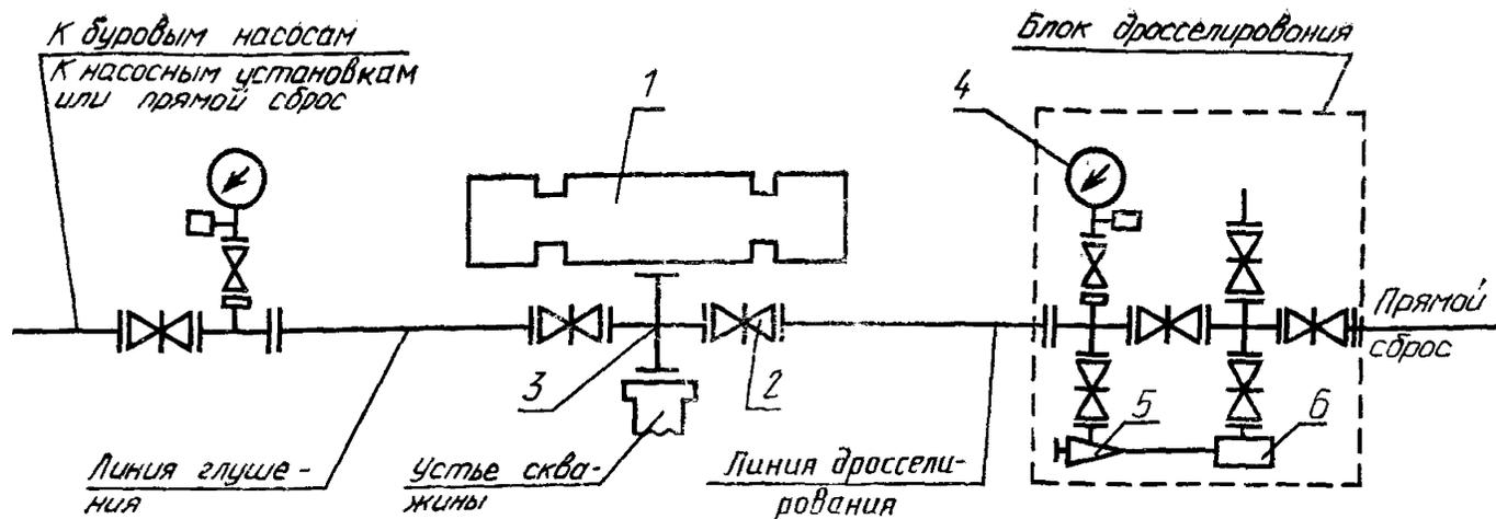
1 — плащечный превентор; 2 — задвижка с ручным управлением; 3 — устьевая крестовина; 4 — манометр с запорным и разрядным устройствами и разделителем сред; 5 — регулируемый дроссель с ручным управлением; 6 — гаситель потока
