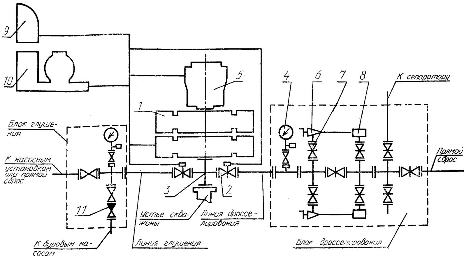
1 — плащечный превентор; 2 — задвижка с гидравлическим управлением; 3 — устьевая крестовина; 4 — манометр с запорным и разрядным устройствами и разделителем сред; 5 — кольцевой превентор; 6 — дроссель регулируемый с ручным управлением; 7 — задвижка с ручным управлением; 8 — гаситель потока; 9 — вспомогательный пульт; 10 — станция гидропривода; 11 — обратный клапан
