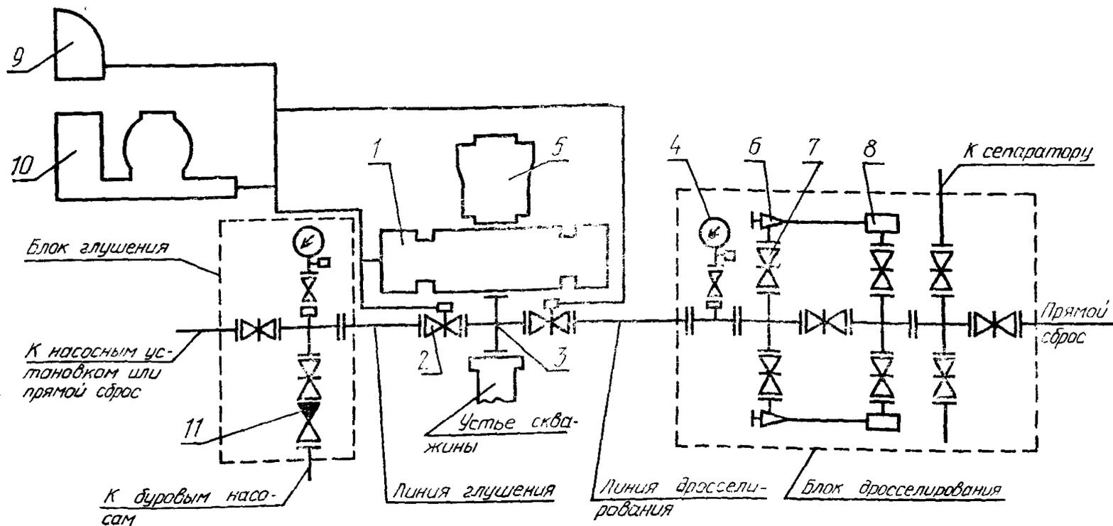
1 — плащечный превентор; 2 — задвижка с гидравлическим управлением; 3 — устьевая крестовина; 4 — манометр с запорным и разрядным устройствами и разделителем сред; 5 — кольцевой превентор; 6 — дроссель регулируемый с ручным управлением; 7 — задвижка с ручным управлением; 8 — гаситель потока; 9 — вспомогательный пульт; 10 — станция гидропривода; 11 — обратный клапан
