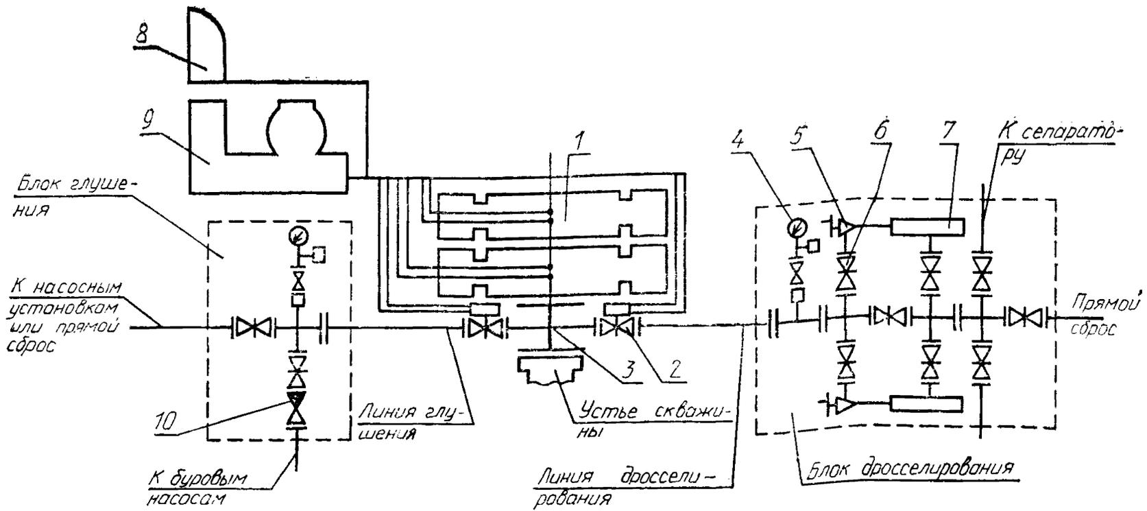
1 — плашечный превентор; 2 — задвижка с гидравлическим управлением; 3 — устьевая крестовина; 4 — манометр с запорным и разрядным устройствами и разделителем сред; 5 — дроссель регулируемый с ручным управлением; 6 — задвижка с ручным управлением; 7 — гаситель потока; 8 — вспомогательный пульт; 9 — станция гидравлического управления; 10 — обратный клапан
